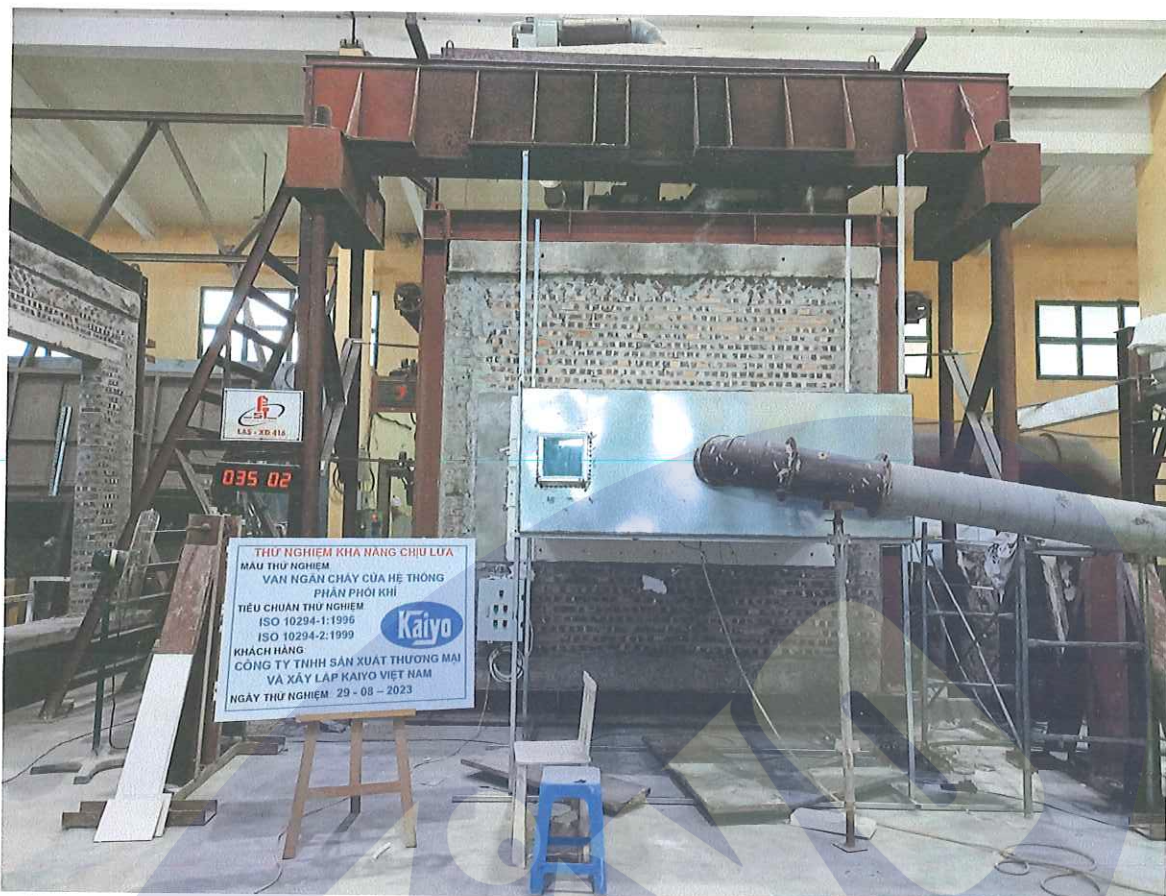
Ảnh D.5: Hệ thống mẫu thử ở thời điểm phút thứ 36 của quá trình thử nghiệm
