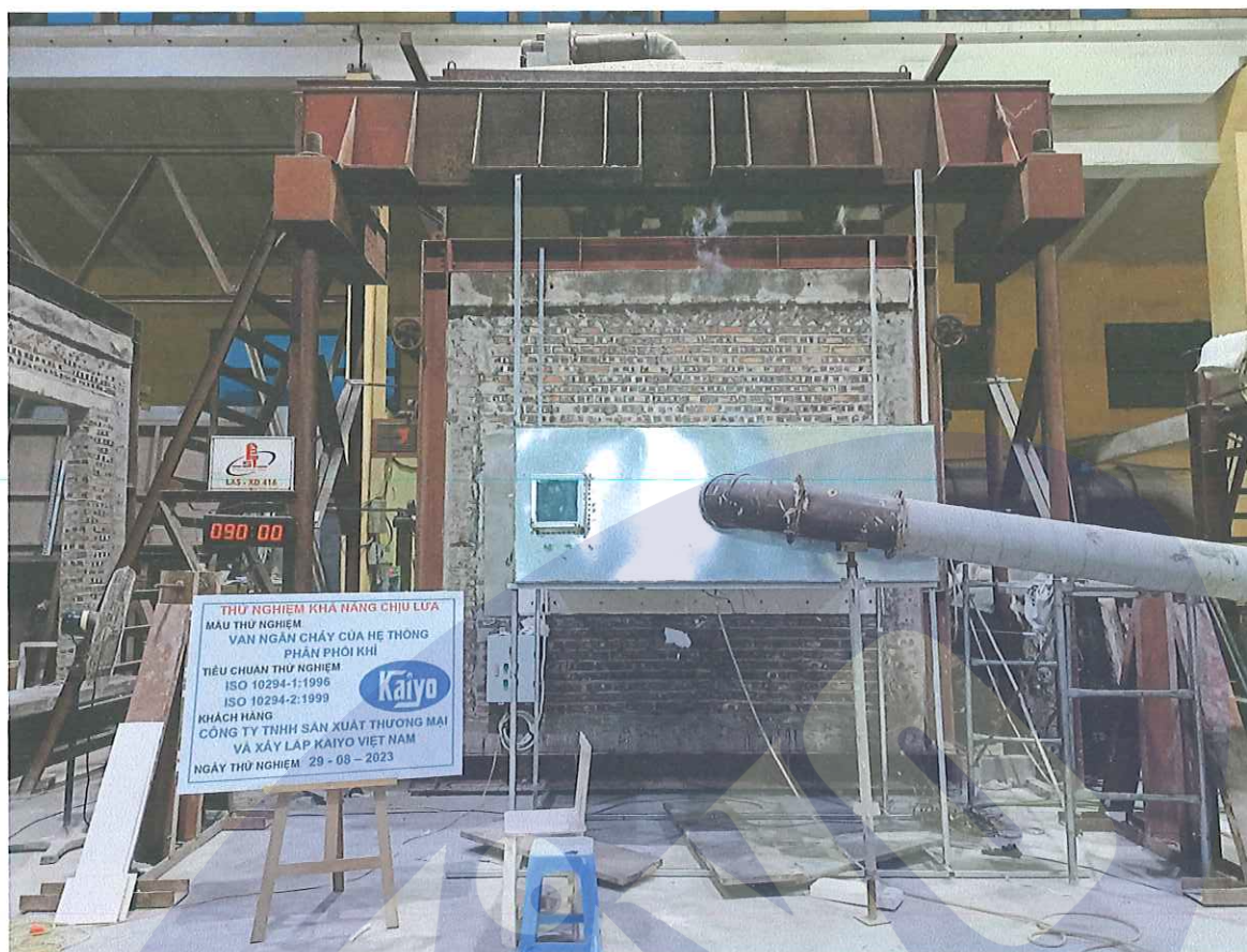
Ảnh D.7: Hệ thống mẫu thử ở thời điểm phút thứ 90 của quá trình thử nghiệm
