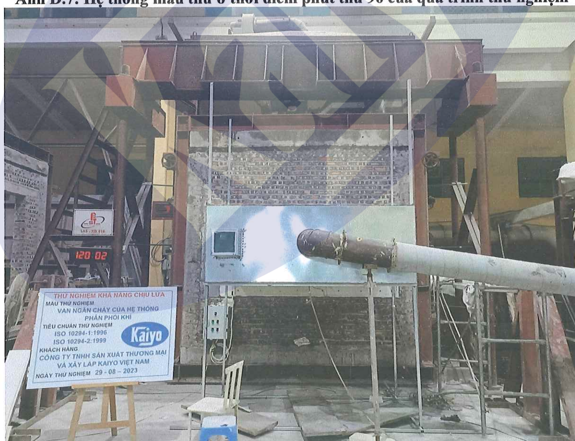
Ảnh D.8: Hệ thống mẫu thử tại thời điểm kết thúc quá trình thử nghiệm
