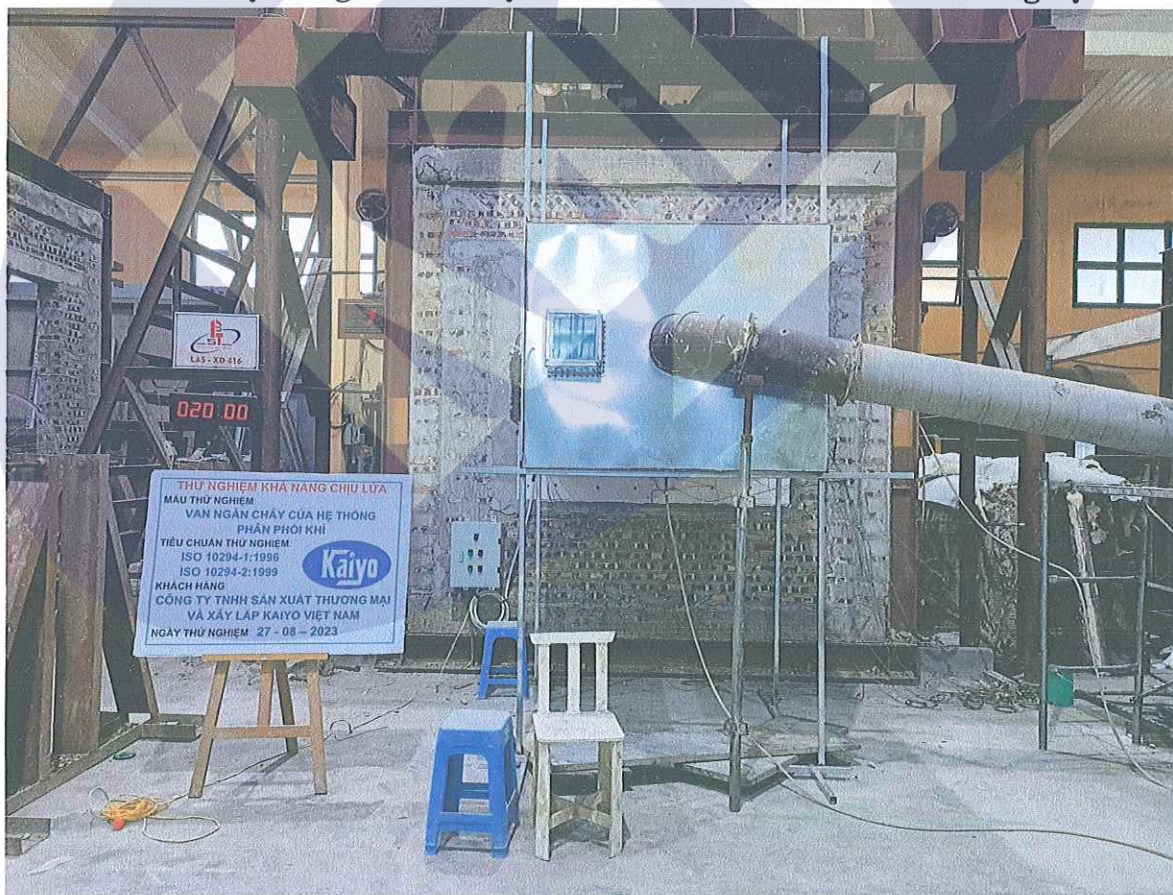
Ảnh D.4: Hệ thống mẫu thử tại thời điểm phút thứ 20 của quá trình thử nghiệm
